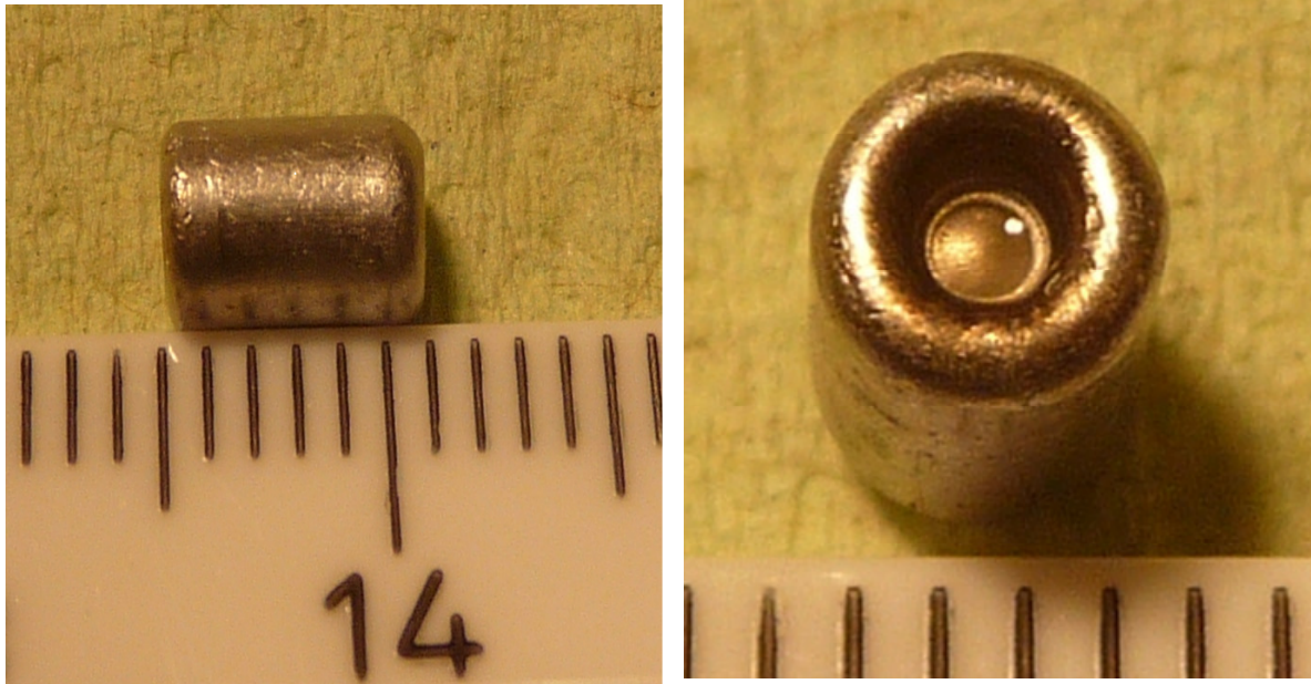
Abbildung 3: Cs-137 Strahlenquelle nach der Reinigung in der ZRA
