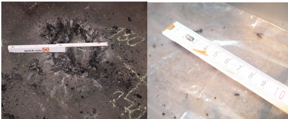
Abbildung 2: Bergung der Strahlenquelle im Asphalt
