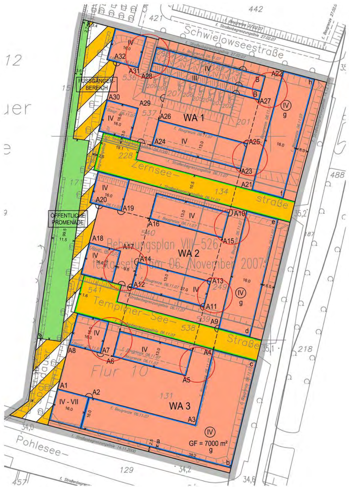
Bereiche mit Abstandsflächenüberlagerungen bzw. Unterschreitung der Regelabstände zwischen Gebäuden mit zulässigem Grenzanbau und Nachbargebäuden
