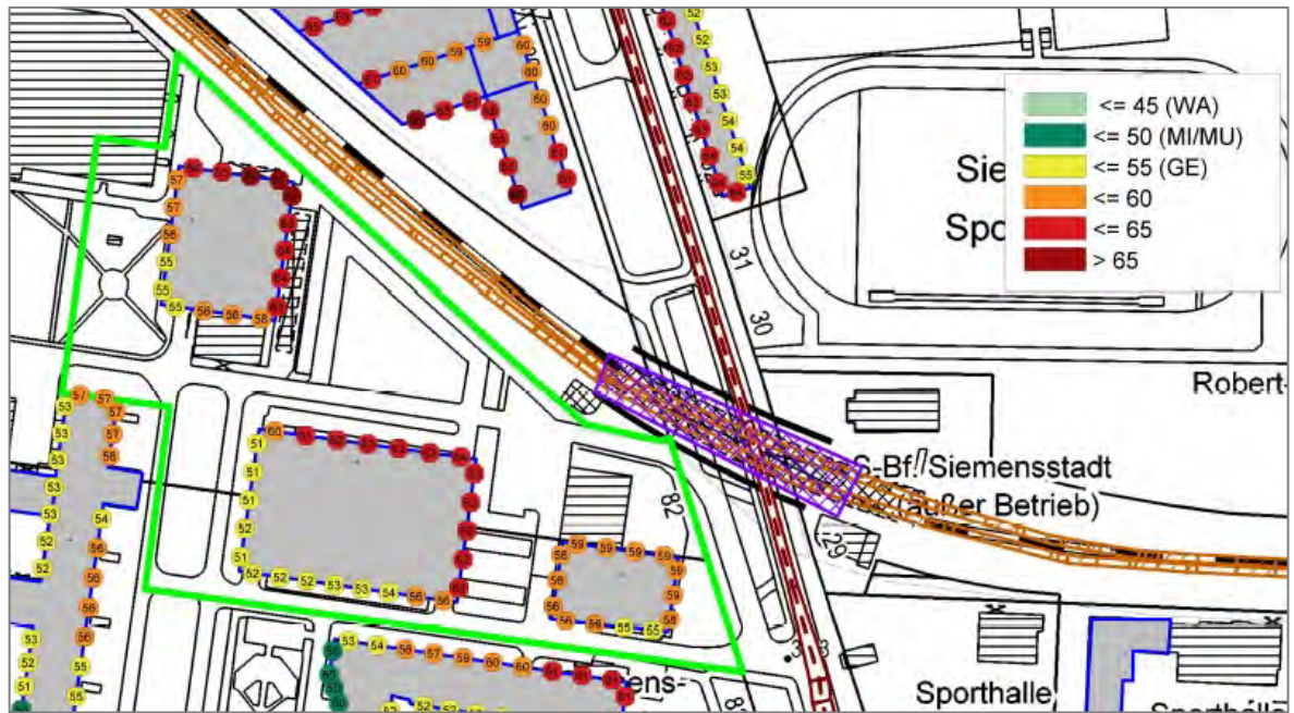
Abbildung 15: Auszug aus der Gebäudelärmkarte: Beurteilungspegel Lr in dB(A), höchster Fassadenpegel, Szenario Gesamtverkehrslärm (Straße Planfall + unterstellte S-Bahn) mit exemplarischen städtebaulichem Entwurf - NACHT 22-6 Uhr. (Quelle: Schalltechnische Untersuchung März 2023, Anhang B, S. 5)
