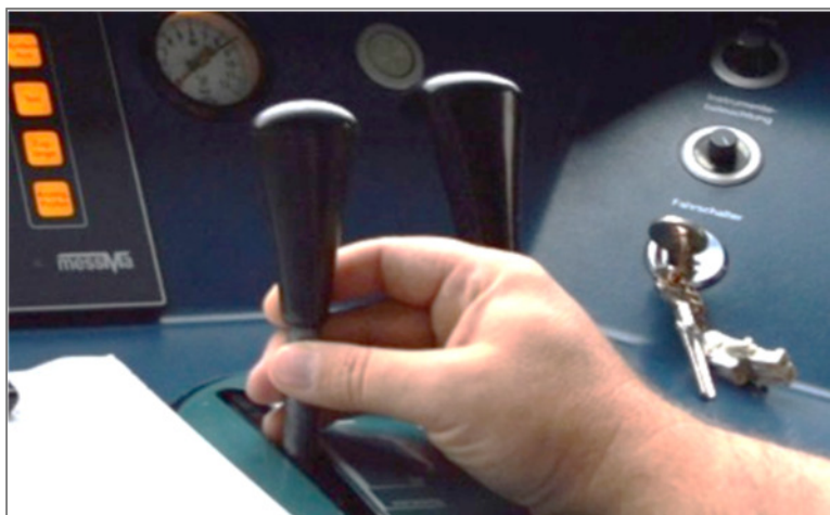
Abbildung 9: Der Fahrschalterschlüssel (rechts) bleibt zukünftig stecken
