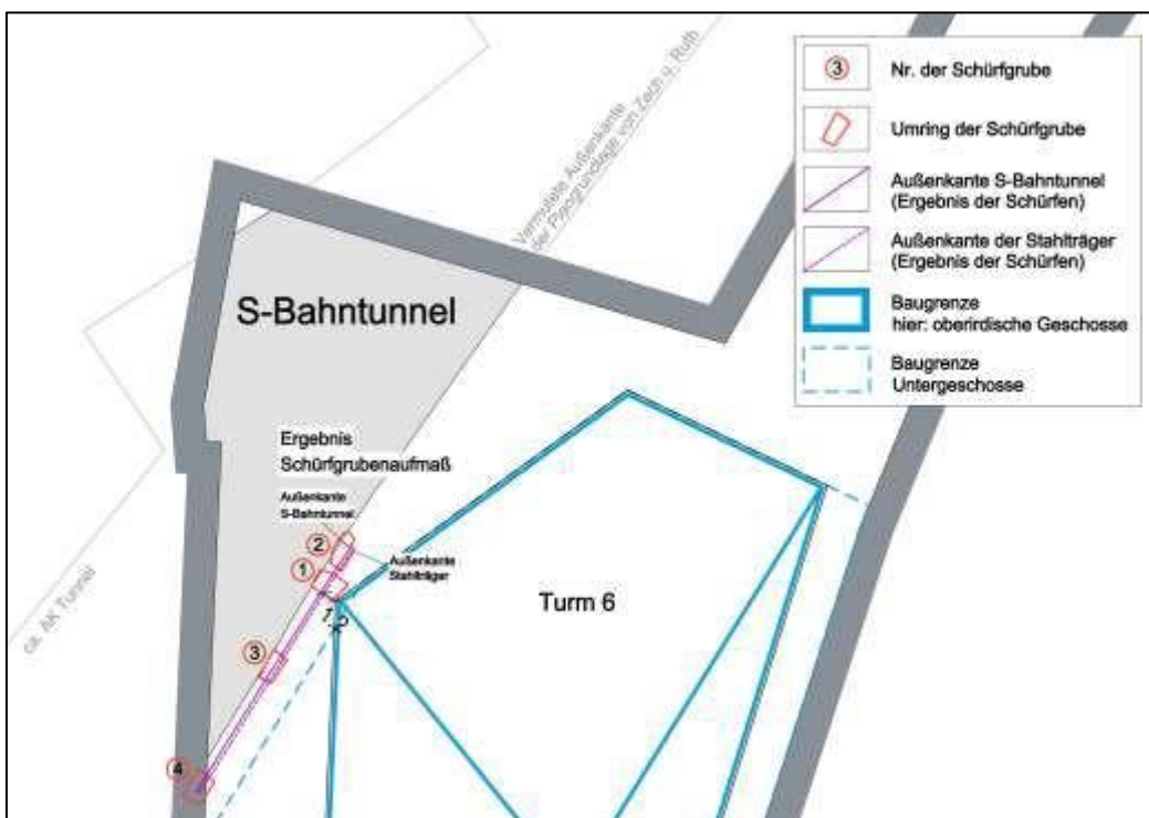
Abbildung 18: Mindestabstand der geplanten Gebäude vom S-Bahntunnel - Obergeschosse
