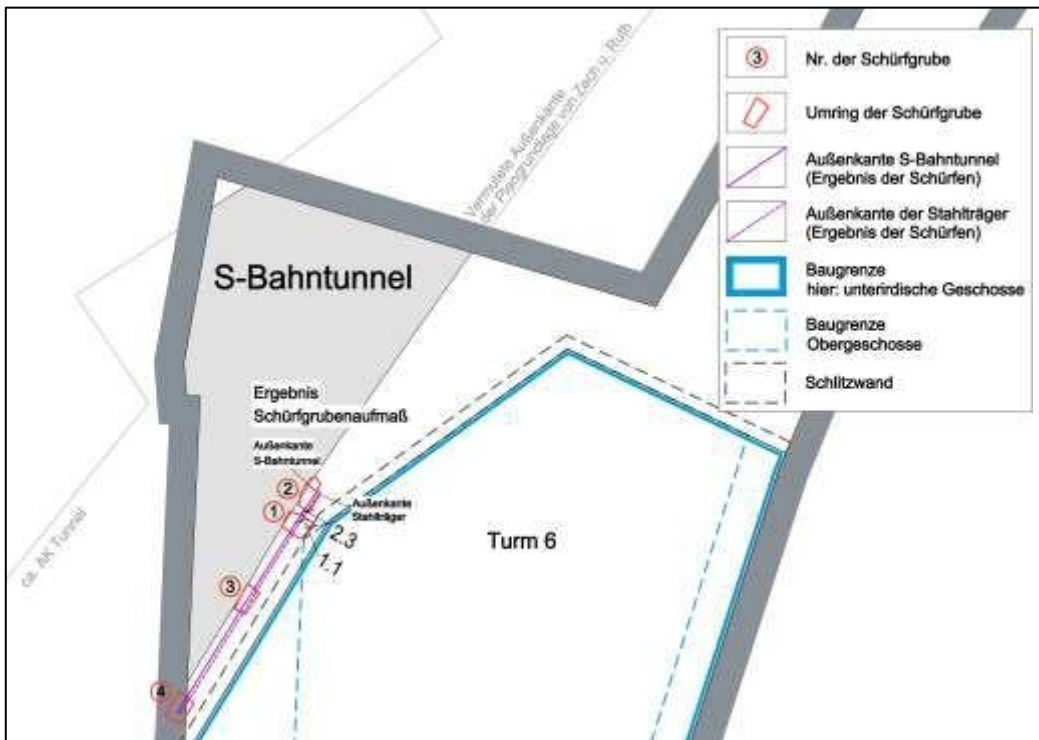
Abbildung 17: Mindestabstand der geplanten Gebäude vom S-Bahntunnel - Untergeschosse
